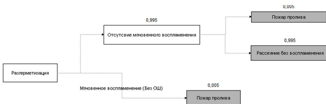
Рис. 1. Дерево событий для частичной разгерметизации технологического оборудования
